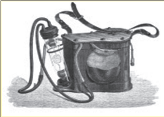
1862 Lampe électrique de mineur Dumas et Benoît
